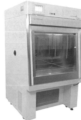
図2 ドアレス恒温恒湿槽「ノードアα」
